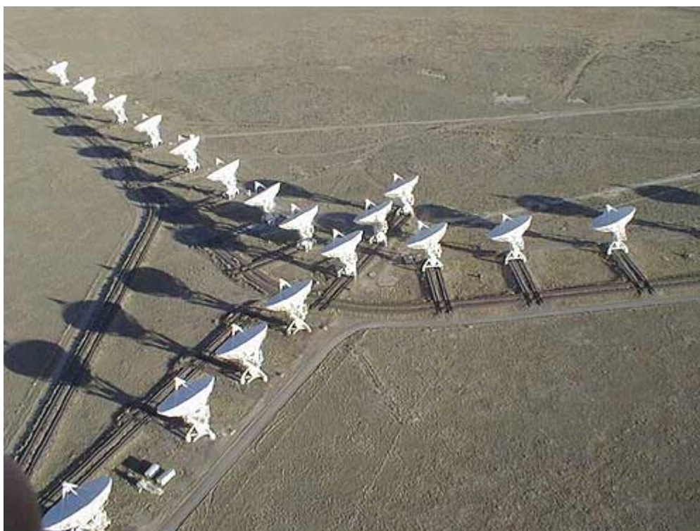
Fig. 5. Interferómetro del Very Large Array (VLA). Consta de 27 antenas de 22 m de diámetro cada una. Cada una de las antenas puede moverse a lo largo de rieles, cuyo diseño sobre el terreno se asemeja al de una gigantesca letra Y. Cada “pata” de la Y posee una extensión máxima de 21 km. La máxima distancia entre las antenas es del orden de 36 km. Para mayor información visitar el sitio http://www.vla.nrao.edu .
