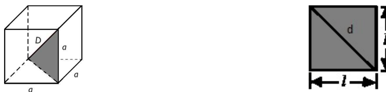
Figura 26. El cubo es un ortoedro en el cual todas sus dimensiones son iguales, es decir que, a = b = c . A la izquierda la diagonal espacial de un cubo y a la derecha la diagonal de un cuadrado, teniendo en cuenta que esta es una figura geométrica plana.
